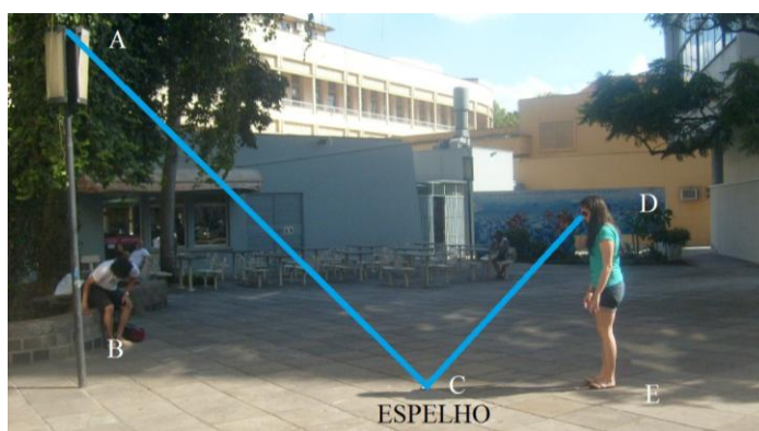
Figura 5: Medindo alturas com o auxílio da semelhança de triângulos. Fonte: os autores
