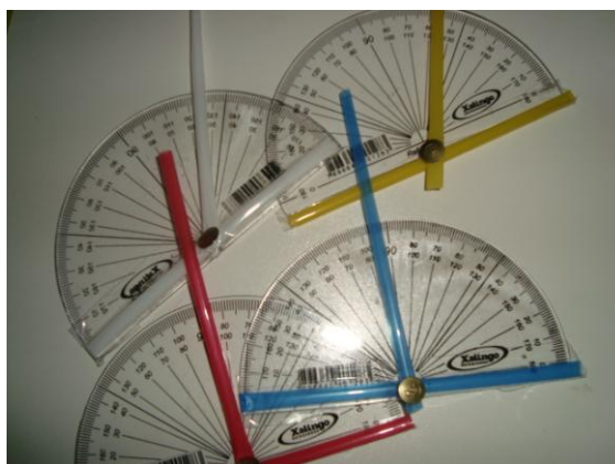
Figura 3 - Teodolito artesanal. Fonte: Os autores.
