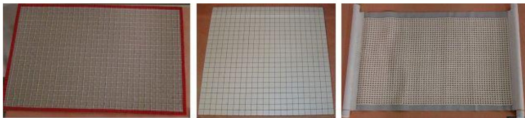
Figura 3 – Malha de linha, malha de madeira e malha plástica com tela antiderrapante. Fotos: Acervo do LEG.
